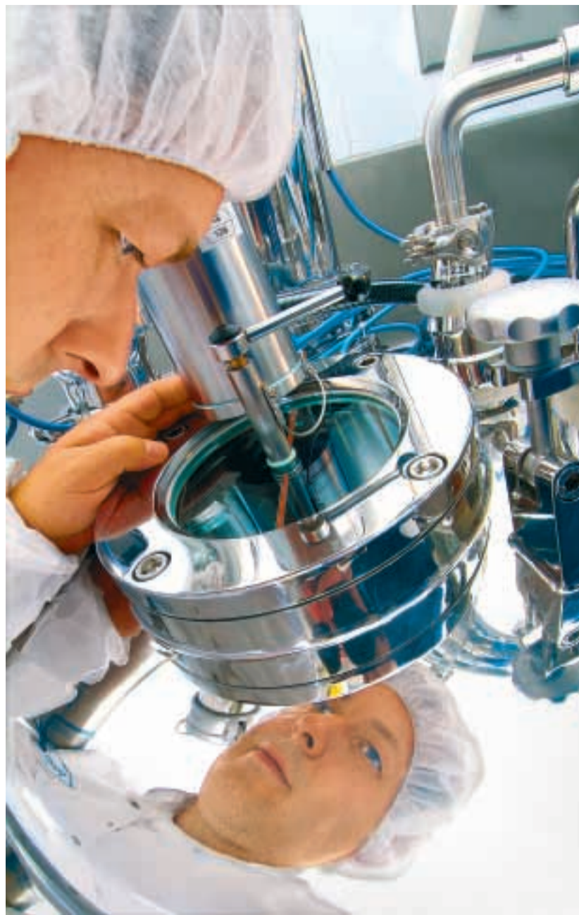
Visuelle Kontrolle. Ein Mitarbeiter beobachtet den Granulierprozess durch das Schauglas des Schnellmischers.
