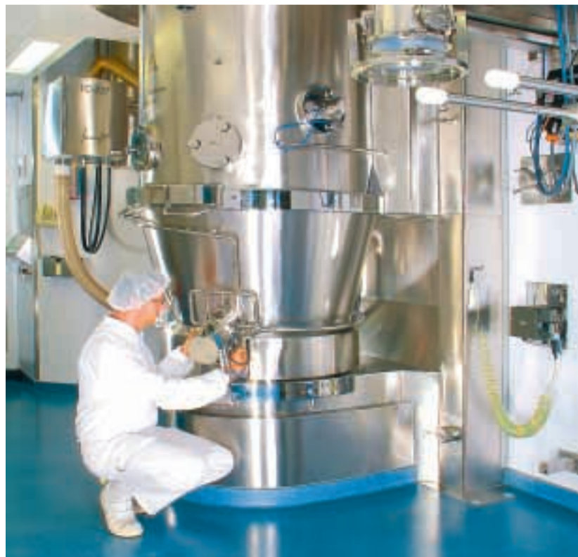
Blitzblank: Im zweiten Obergeschoss des Baus 27 kontrolliert ein Mitarbeiter die einzelnen Teile des Wirbelschichtgranulators. Produktions- und Technikbereich sind aus Gründen der guten Herstellpraxis (GMP) voneinander getrennt.
