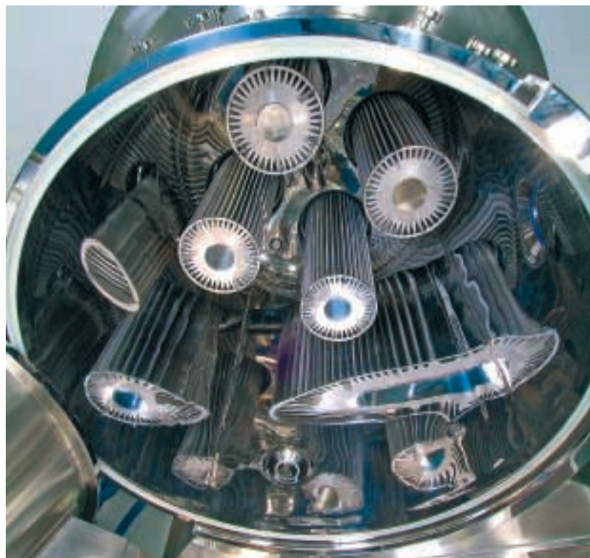
Kein Raumschifftriebwerk, sondern Filterkerzen im Innern des Wirbelschichtgranulators. Sie sorgen für das Absaugen der feuchten Trocknungsluft und verhindern gleichzeitig, dass das im Trocknungsprozess verwirbelte Granulat in die Aussenwelt gelangt.
