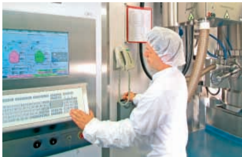
Hightech vom Feinsten: Die computerisierte Steuerungseinheit der neuen Granulierlinie im zweiten Obergeschoss. Von hier aus kann die ganze Anlage programmiert, gesteuert und überwacht werden.
