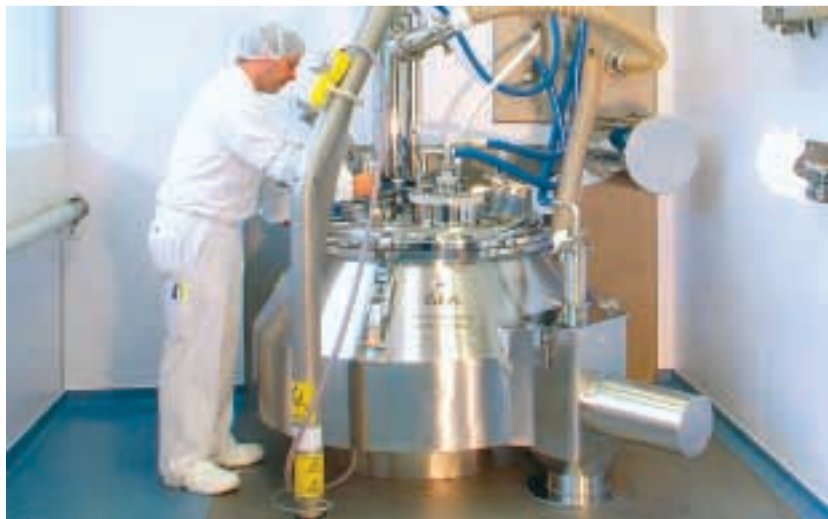
Schnellmischer mit heizbarem Doppelmantel im dritten Obergeschoss. In dieser Apparatur werden Hilfs- und Wirkstoffe mit der Granulierflüssigkeit zum eigentlichen Granulat vermischt.
